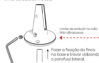
2. Fazer a fixação do produto na base estabilizadora e travar utilizando o parafuso lateral.
