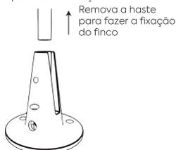
1B. Fazer a fixação do finco na base estabilizadora e finque na terra, respeitando o limite da base com o solo.
